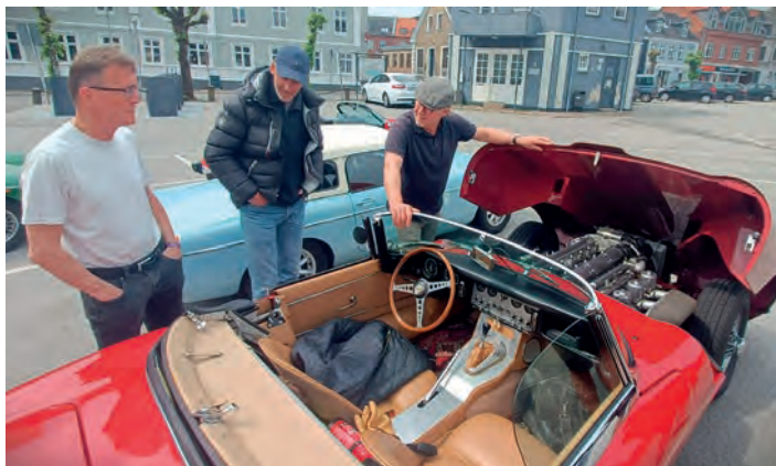
Magne Bjervas vakre Jaguar E-type Serie-1 hadde litt lumske bremses nedover. Vakumbryteren på bremseforsterkeren hadde satt seg fast. Ble fikset, og alt fungerte bra. Konsulenter: Geir Olav Øye (t.v.) og Per Tore Lunden.
